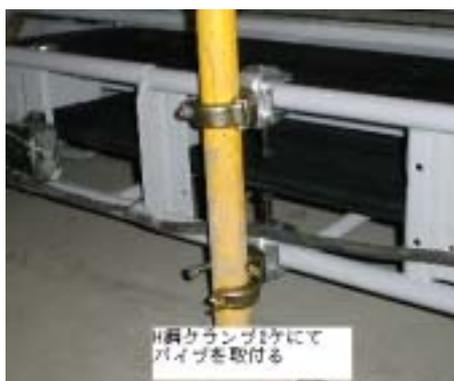
カムスイッチをパイプに取付ける（カムスイッチ取付クランプを用品ます）
