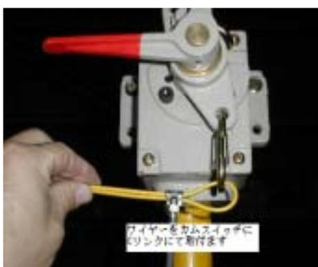
カムスイッチからワイヤーを引張り C リンクを通してクリップにて固定する。
